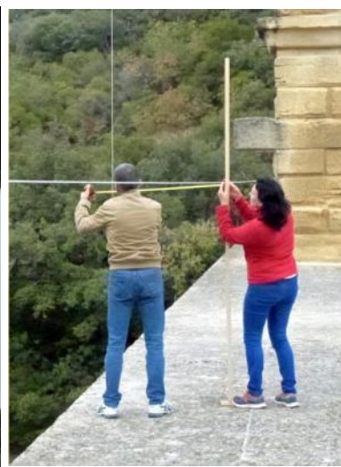
Les mesures du 22 septembre 2017: à gauche, la mise en place de la perche et du fil à plomb depuis la conduite du 3ème niveau Au centre, mesure côté amont; à droite mesure côté aval.
