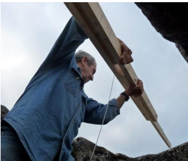
Les mesures du 22 septembre 2017: à gauche, la mise en place de la perche et du fil à plomb depuis la conduite du 3ème niveau Au centre, mesure côté amont; à droite mesure côté aval.
