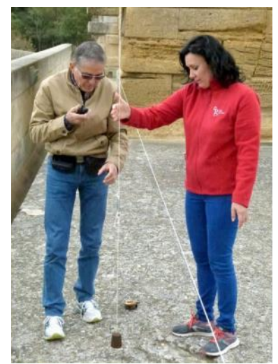
Les mesures du 22 septembre 2017: à gauche, la mise en place de la perche et du fil à plomb depuis la conduite du 3ème niveau Au centre, mesure côté amont; à droite mesure côté aval.
