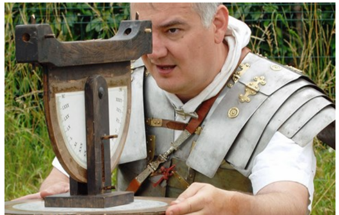
Démonstration de l'utilisation de la groma (à gauche) et de la dioptra (à droite) par des membres de l'association Legio VIII Augusta
